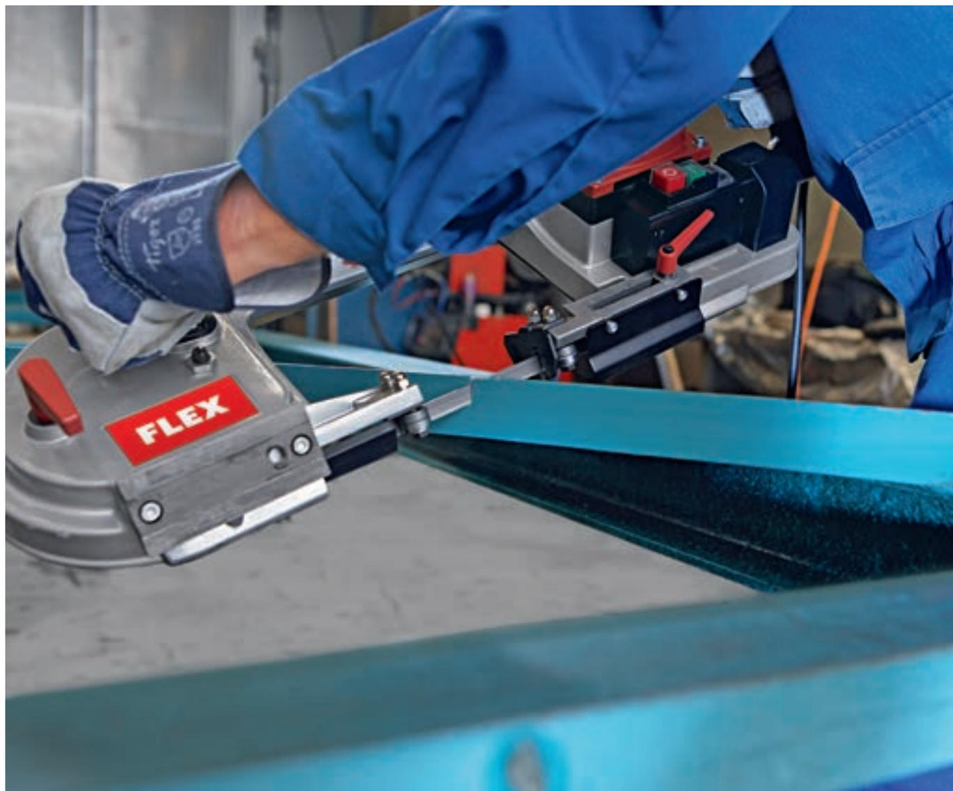
Эргономичная ручка обеспечивает уверенное ведение пилы при стационарном и портативном применении. Для надежной безинструментальной фиксации пилы после портативного применения SBG 4910 оснащена зажимом типа «ласточкин хвост». Стопор фиксирует пилу на столе и таким образом предотвращает повреждение при транспортировке.
