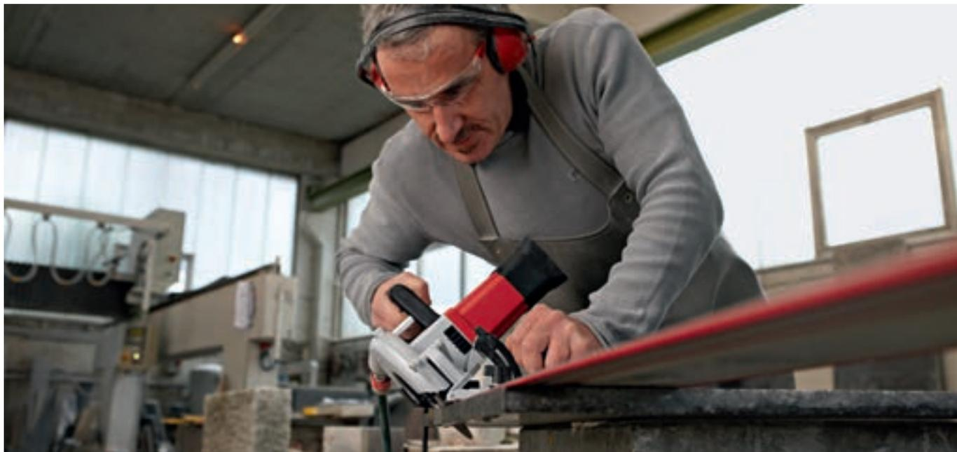
Алмазная камнерезущая машина CS 60 WET позволяет не только выполнять быстрые и точные прямыерезы, но и идеально подходит для косой распиловки в диапазоне от 0 до 45°.
