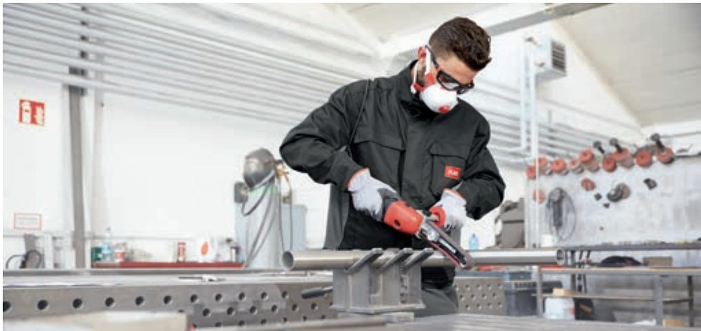
Мощный ленточный напильник FBE 8-140 предназначен для шлифования, сатинирования и удаления заусенцев. Для идеальной адаптации к любому рабочему положению шлифовальная насадка поворачивается на 270°. Для замены шлифовальной ленты и регулировки направляющей не требуются специальные инструменты. Для работы на скорости, соответствующей особенностям материала, модель FBE 8-140 оснащена системой плавной регулировки частоты вращения.
