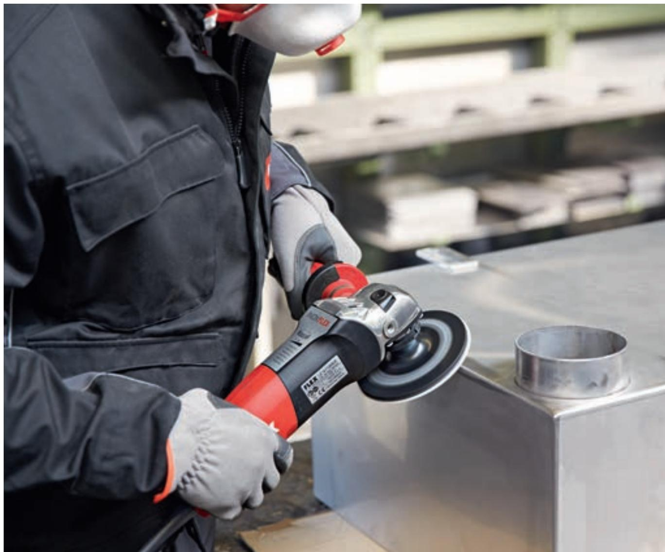
INOXFLEX прекрасно подходит для зашлифовки сварных швов, притупления и скругления кромок, а также выполнения очистных и финишных работ по нержавеющей и обычной стали, легким и цветным металлам. Специальное передаточное отношение редуктора обеспечивает высокий крутящий момент в среднем и низком диапазоне частот вращения. Это предотвращает посинение и перекокс в результате выделения тепла.
