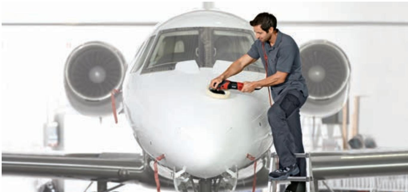
Идеально подходит для полирования самолетов благодаря небольшому весу и удобному удержанию. Полировальные диски с диаметром до 250 мм позволяют легко справляться с большими по площади горизонтальными и вертикальными поверхностями.
