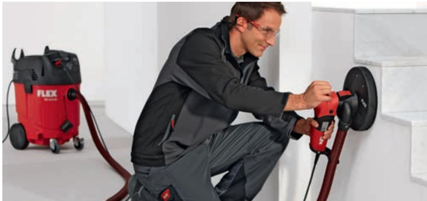
Машина Handy-Giraffe® WSE 7 Vario оборудована высокоэффективной системой пылеудаления. Присоединение пылесоса с помощью системы фиксаторов FLEX Clip выполняется быстро и просто, а пылеудаляющий шланг крепится к машине и не мешает работе. Рекомендуется совместное использование с безопасным пылесосом FLEX (начиная со стр. 222).
