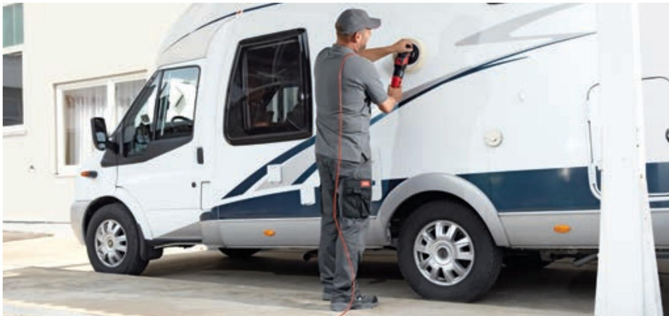
В первую очередь PE 14-1 180 поражает своим высоким тяговым усилием при незначительном уровне шума. Благодаря оптимальному охлаждению способна выдерживать большие нагрузки, прежде всего, в нижнем диапазоне частоты вращения. Переключатель ускорения гарантирует плавный и медленный старт.
