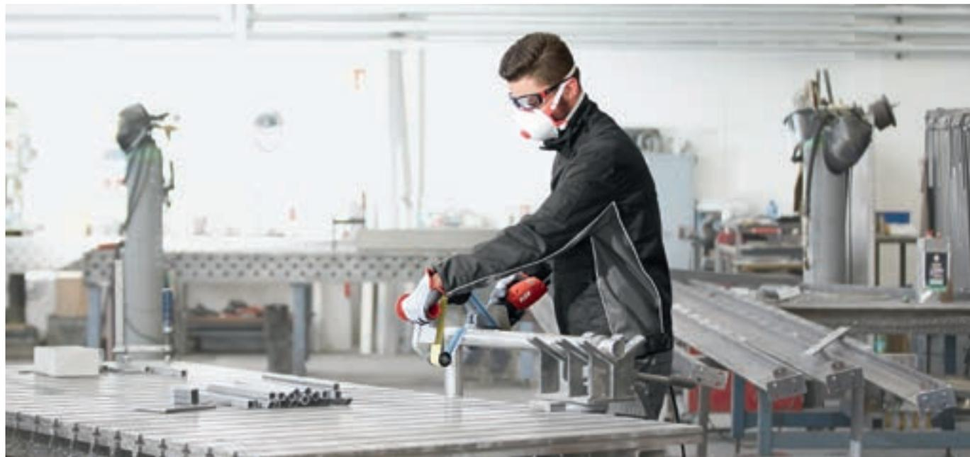
Для грубой шлифовки, сатинирования и полирования до зеркального блеска нержавеющей стали и других материалов. Большой угол охвата до 270° позволяет обрабатывать трубы всего в два этапа. Благодаря плавно регулируемой частоте вращения можно оптимально подобрать скорость ленты, исходя из особенностей материала. Точный ход шлифовальной ленты обеспечивает однородный рисунок поверхности. Для замены шлифовальной ленты не требуются инструменты.
