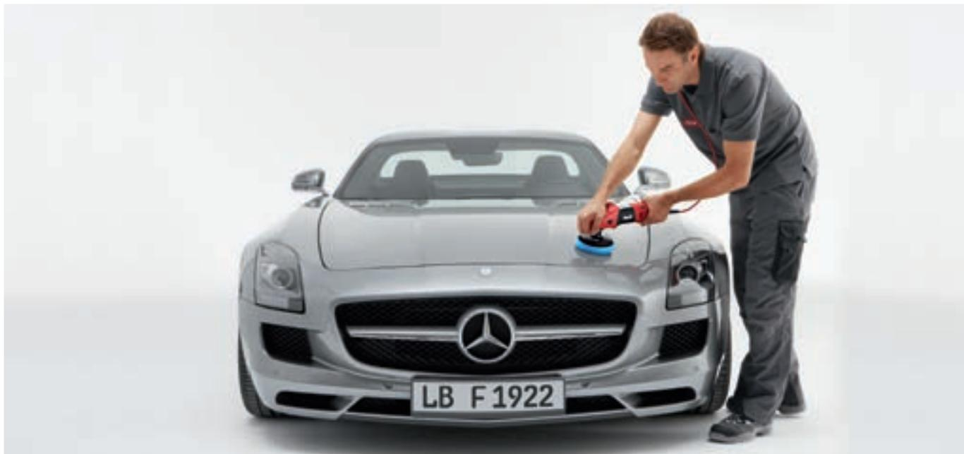
Для достижения отличного результата очень важна совместимость машины и политуры или губок/подушечек. Использование тех или иных принадлежностей обусловлено характером повреждения лакокрасочного покрытия (царапина, голограмма и т.д.). Более мелкие царапины могут удаляться с помощью голубой полировальной губчатой насадки и шлифовальной полироли FLEX.
