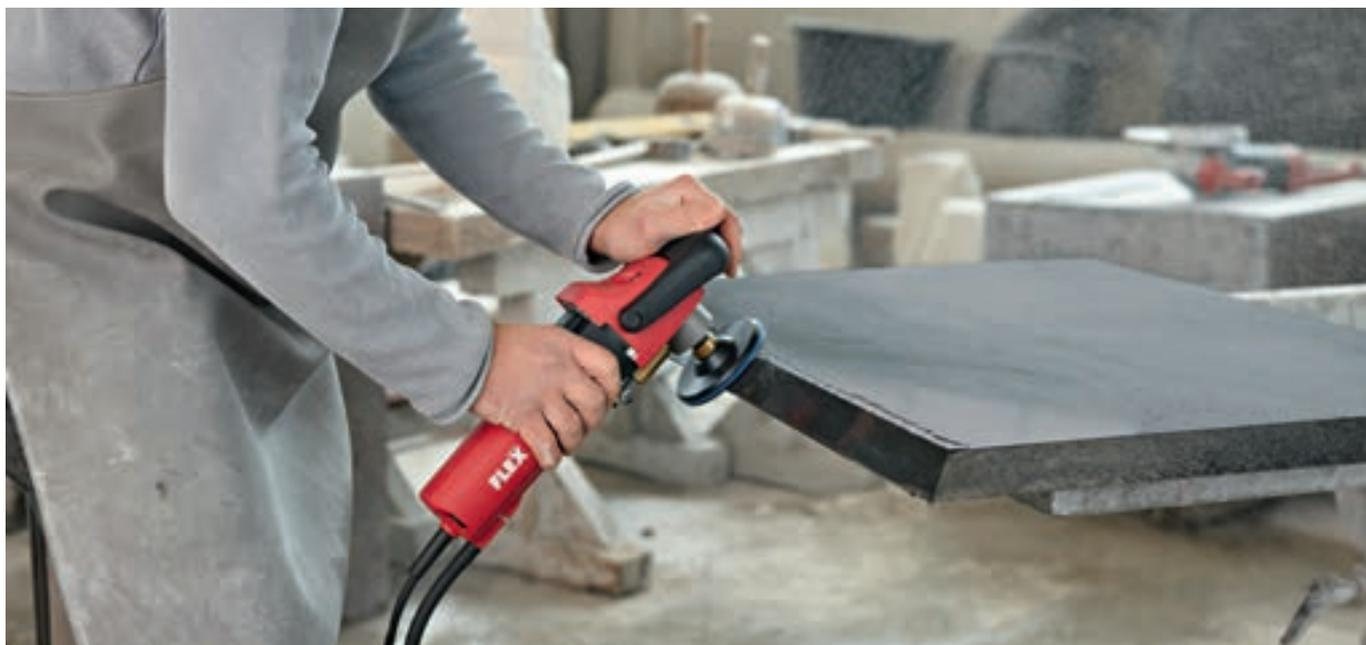
Машины для полирования камня с подачей воды L 12-3 100 WET, LE 12-3 100 WET в комбинации с алмазными дисками FLEX на «липучке» оптимально подходят для полирования кромок реза.
